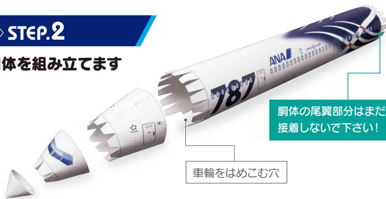
しっかりと丸みのくせをつけたあと、のりしろにのりをつけ、接着します。接着のズレがないように十分注意してください。なお、下部の車輪をはめこむ穴も忘れずに切り取ってください。
