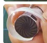
前面にファンを付けカウルを外側からかぶせるように取り付けます。
