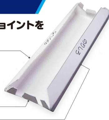
図のようにのりしろを作ります。この部品は、側面と下面は主翼に、上の部分は胴体に接着されます。
